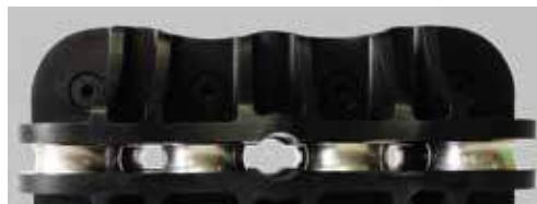
Orificio central enderezadora de tubos
