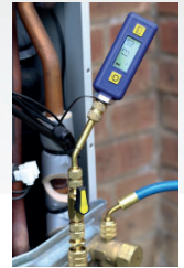
Précision : Raccord femelle évasé 1/4" coudé à 45 degrés, qui se connecte directement au système pour permettre une lecture plus précise
