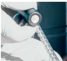
Injektion des Färbemittels durch Drehen des Griffs.
