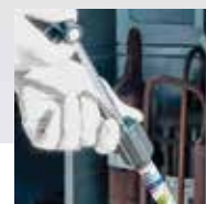
Injection du colorant en tournant la poignée.
